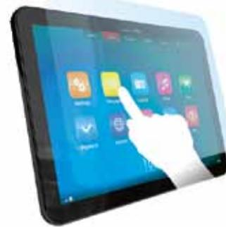
タッチパネル用など、画面に直接貼り付ける薄型フィルターは、特許出願中のオリジナル粘着テープで簡単に取り付け出来る。
