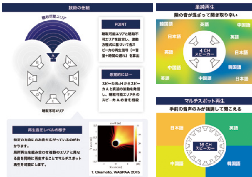
図1:音声マルチスポット再生技術のしくみ
