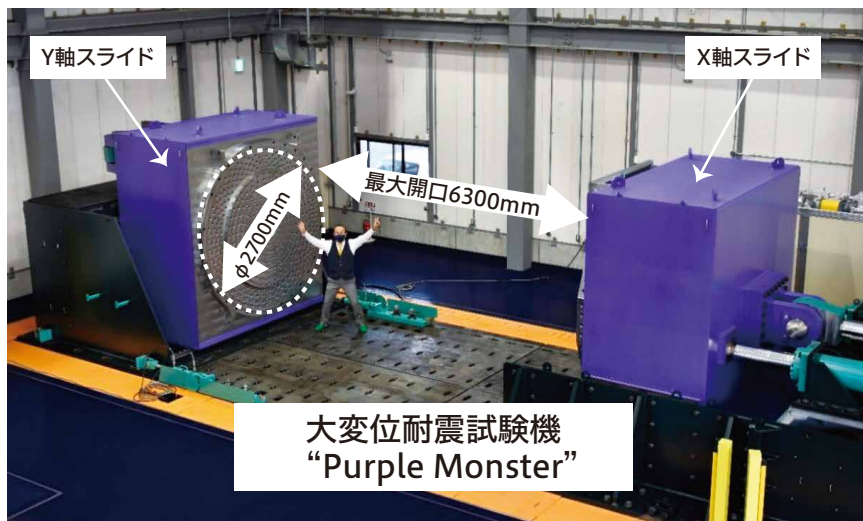
直径2700mm、全長6300mmまでの大口径管の実物大作動実験が可能な世界最大規模の試験機
