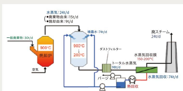
水蒸气回収システムを組み込んだ廃棄物焼却施設(広島大学提供)
