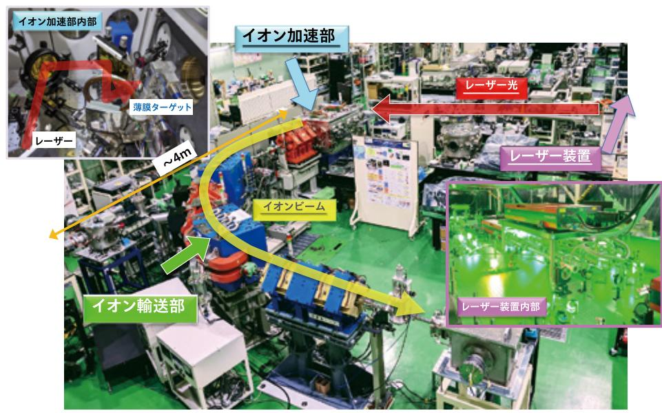
(図2) 完成したレーザー駆動イオン入射器の原型機
